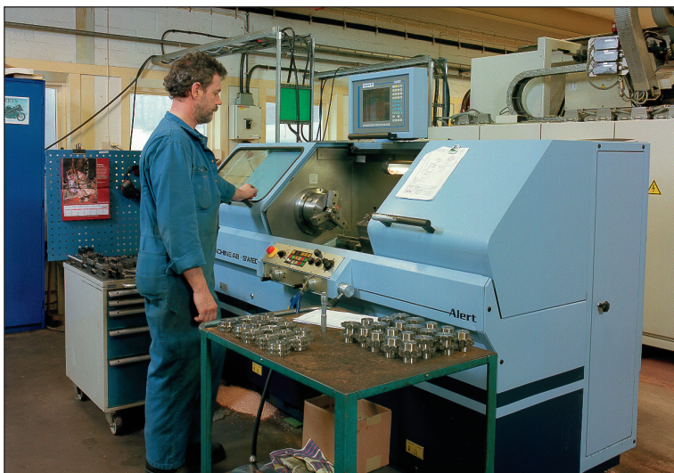
CNC svarv för bearbetning av standarddetaljer. Storebro Alert typ Tech-In.
